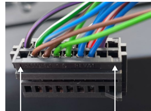
Stecker hinter dem Kombiinstrument. Dort befinden sich zwei identische Can-Bus Paare. Pin 11 & 13 und Pin 12 & 14. Beide Paare können verwendet werden.
