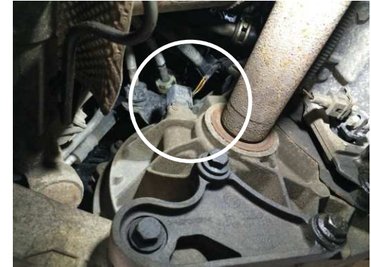
Das Geschwindigkeitssignal liegt evtl. auch am Radiostecker an / Grün/Weißes Kabel.
